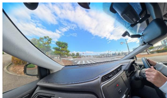
図3 360度撮影可能カメラによる実車評価の様子
