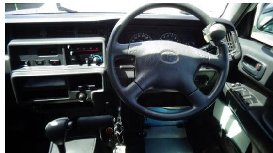
図3 手動式アクセルブレーキ車両
