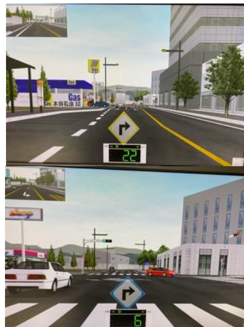
図3 失語症に対するコースでの右折時の画面音声によるナビゲーションと同時に右折方向への標識が視覚的に示されて、右折後この標識は消える。これ以外に右左折、合流、踏切ありなどの音声に合わせて標識が画面上に示される。
