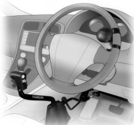
両足が不自由な方の為の 手動運転装置(FC-B型)
